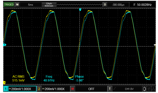
Fig. 7. Diferencia de fase introducida por el sensor de corriente (Amarillo: Punta de corriente Rigol. Celeste: Sensor de corriente SCT013).
